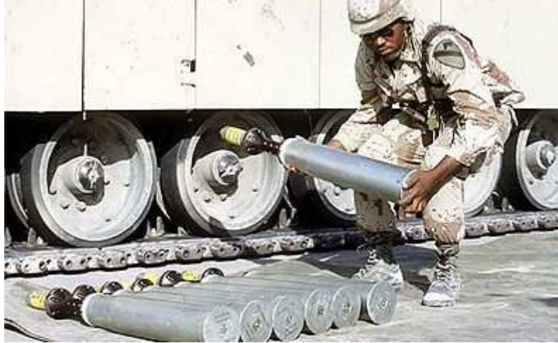
Soldat états-unien manipulant des obus de tank pourvus de pointes à l'uranium appauvri
